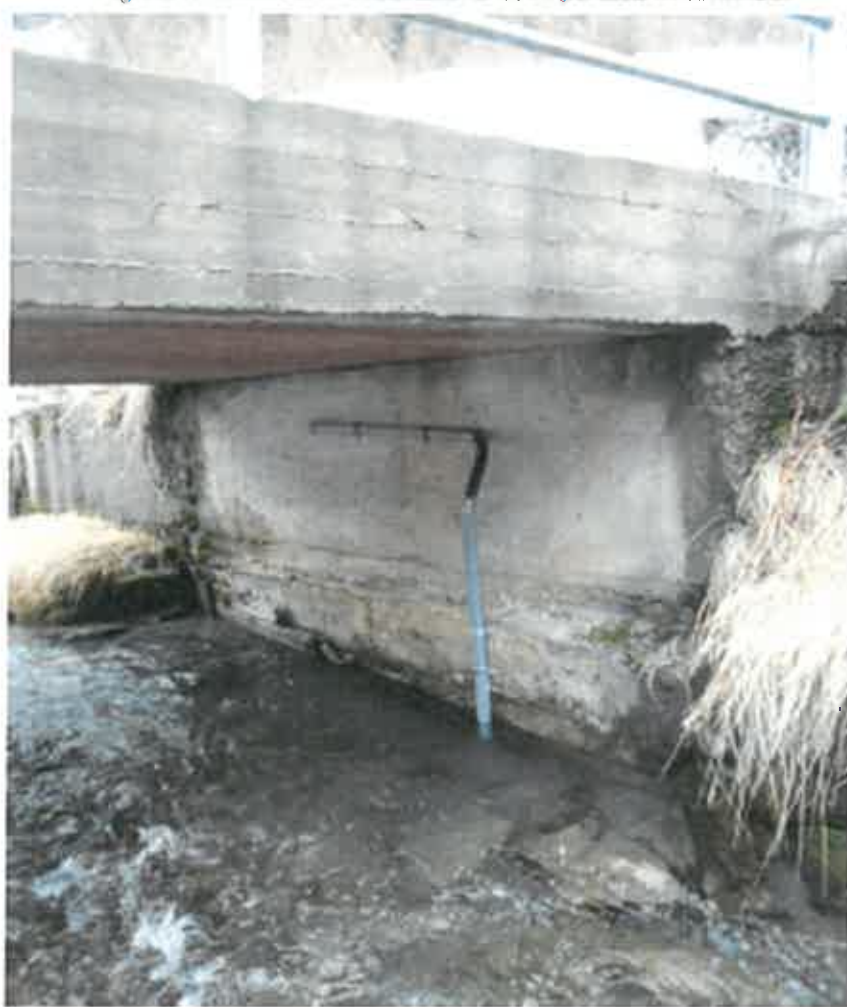
Figura 6: stazione di misurazione delle portate in continuo.
